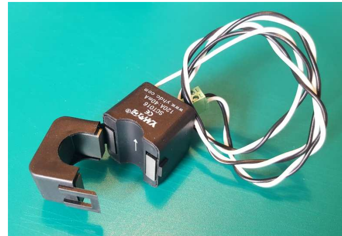
Bild 3 Stromsensor. Der Pfeil muss in Stromrichtung (Richtung Haus) zeigen.
